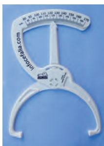
Fig. 12 – Craneómetro de Infocefalia. Diseñado por el Ingeniero David Verde, aporta importantes modificaciones al clásico cefalómetro de Bertillon. No solo por sus dimensiones, mas fácilmente manejable, y por su bajo coste, sino por la aplicación de conceptos matemáticos que corrigen la medición de fragmentos de circunferencia, como hace el Bertillon, convirtiéndolos en medidas lineales equiparándolas a las obtenidas sobre fotografías, recurso habitual en neurocirugía, transformándolo en una herramienta indispensable para el seguimiento en la Atención Primaria.
